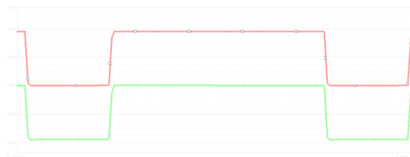
شکل (۲) شکل امواج ولتاژ گیت برای سوئیچ های S_1 و S_2 .
