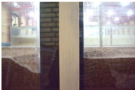
شکل ۶: چاله آبشستگی تکیه گاه مستطیل بر بستر یکنواخت از نماهای مختلف
