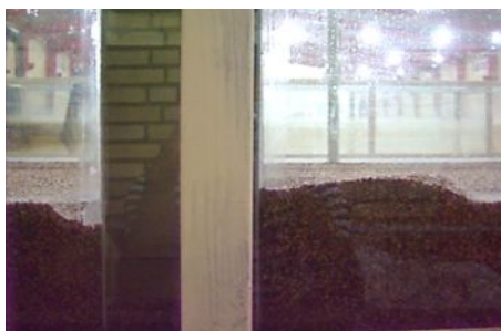
شکل ۸: چاله آبشستگی تکیه گاه نیم دایره بر بستر یکنواخت از نماهای مختلف
