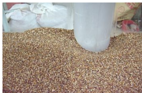
شکل ۸: چاله آبشستگی تکیه گاه نیم دایره بر بستر یکنواخت از نماهای مختلف
