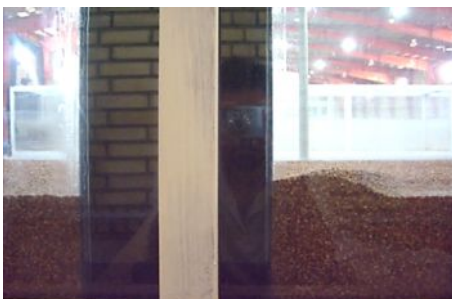
شکل ۷: چاله آبشستگی تکیه گاه ذوزنقه ۴۵° بر بستر یکنواخت از نماهای مختلف
