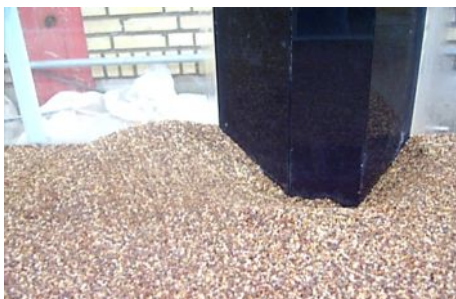
شکل ۷: چاله آبشستگی تکیه گاه ذوزنقه ۴۵° بر بستر یکنواخت از نماهای مختلف
