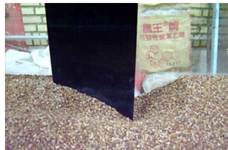
شکل ۶: چاله آبشستگی تکیه گاه مستطیل بر بستر یکنواخت از نماهای مختلف
