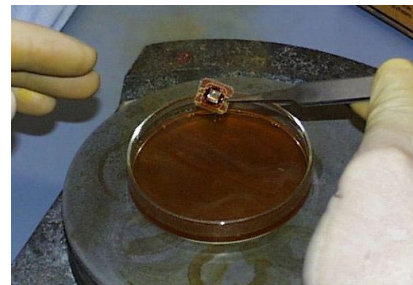
شکل ۱. تراشه را در اسید نیتریک بالای ۹۸ درصد قرارداده و بسته آنرا باز می کنیم
