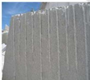
شکل (۱) : بلوک کرانیت و بقایای عوامل تخریب شیمیایی شکل (۲) : قواره کردن یک کرانیت با استفاده از نعل و پارس
