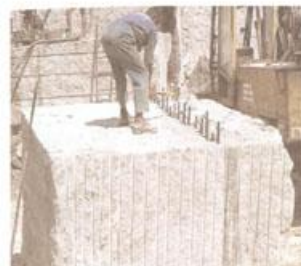
شکل (۱) : بلوک کرانیت و بقایای عوامل تخریب شیمیایی شکل (۲) : قواره کردن یک کرانیت با استفاده از نعل و پارس
