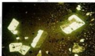
شکل 17: بافت پورفیریک برلیت با ماکل کارلسیاد در سنلیدین های (XPL- 40X) آن
