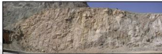
شکل ۴: بلوک پیش‌برشی پس از انفجار |۸|
