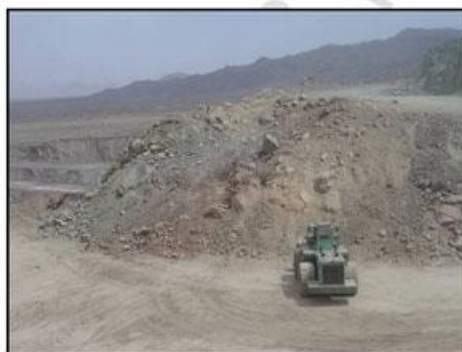
شکل ۶: دیواره حاصل از سومین بلوک پیش برشی [۱]
