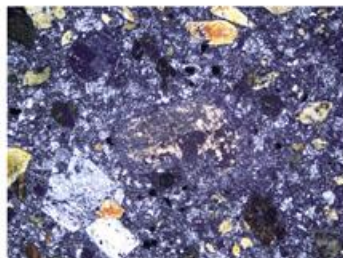
شکل ۴- دگرسانی کربنات از مرکز بلور پلازیوکالز (XPL)
